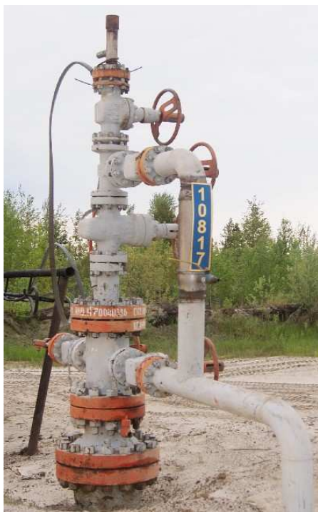
Установка пробоотборника ППЖР-01 (вертикальное размещение) с бесфланцевым соединением на скважине ОАО «Самотлорнефтегаз»
